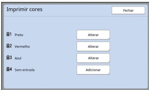
Toque em [Alterar] para alterar a cor de impressão que está especificada para cada master. Se pretender imprimir com duas ou mais cores, toque em [Adicionar] para adicionar cores de impressão.
